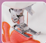
stopka otwarta (standard w maszynach F600)
